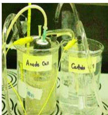
Celula de biocombustie bicamerala separata de punte de o punte de sare ix .
